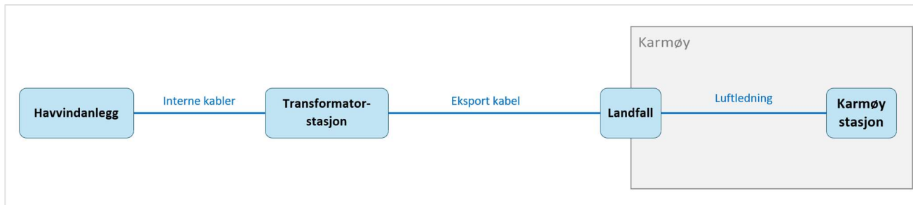
Figur 4-2. Skjematisk presentasjon av det meldte anlegget
